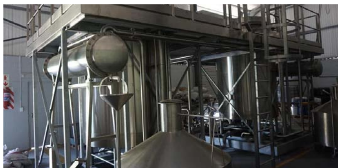
In der Destillier-Anlage werden aus Rosmarien und Lavendel ätherische Öle gewonnen.
