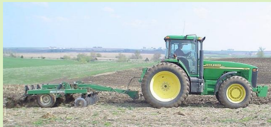
Abb. 1: Traktor mit Scheibengrubber, eine gute Möglichkeit, eine reduzierte Bodenbearbeitung mit einer Tiefe bis 15 cm zu erreichen.;
